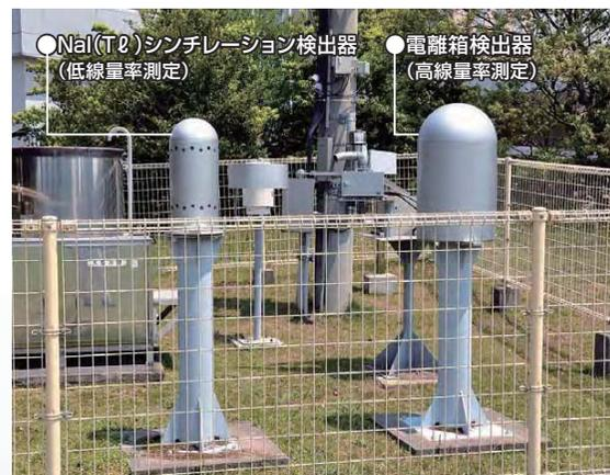
空間放射線（ガンマ線）を測定します。NaI(Tl)のシンチレーション検出器は、低いレベルの空間放射線の測定に適しており、大気中や地面から出る自然放射線を測定します。また、ガンマ線エネルギーによる放射性物質の種類解析も可能です。電離箱検出器は緊急時の高いレベルの空間放射線を測定するために設置しています。大気中や地面からのガンマ線の他に高エネルギーの宇宙線も測定しますので、平常時でもNaI(Tl)シンチレーション検出器の測定値よりもやや高い値を示します。
