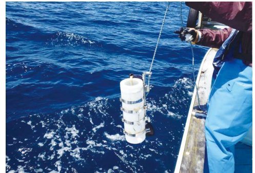
海水採水の状況(バンドーン採水器)
