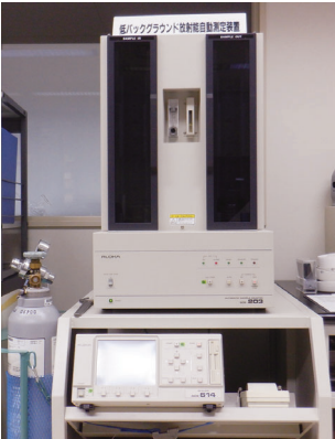
ストロンチウム90を測定する低バックグラウンドベータ線測定装置
