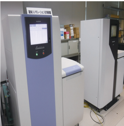
トリチウムを測定する液体シンチレーション計測装置
