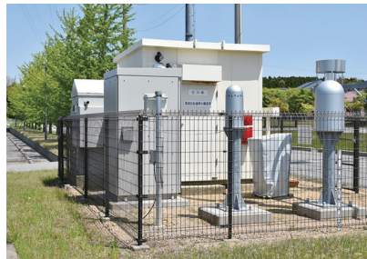
環境放射線観測局 (押水局：宝達志水町(地図下線)) 空間放射線や風向、風速などを測定しています。
