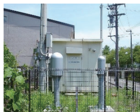
環境放射線観測局 (田鶴浜局：七尾市(地図下線)) 空間放射線や風向、風速などを測定しています。
