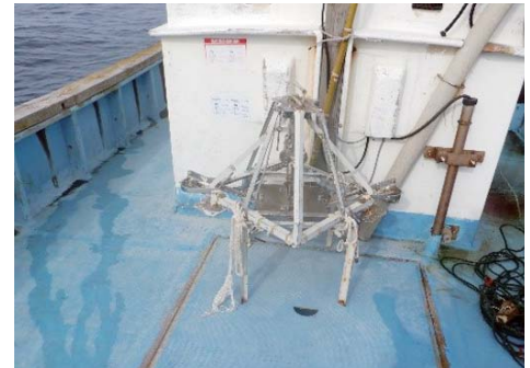
▲スミス・マッキンタイヤ採泥器:底質試料の採取
