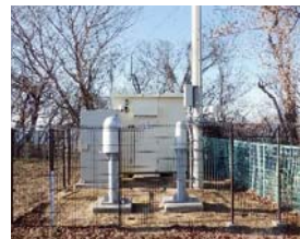
環境放射線観測局 (一ノ宮局：羽咋市(地図下線)) 空間放射線や風向、風速などを測定しています。
