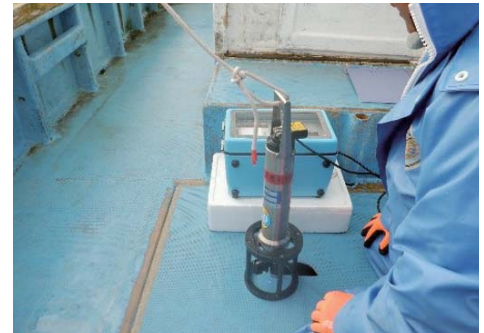
▲ CTDセンサー：水温、塩分の測定
