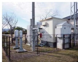
環境放射線観測局 (未坂局：中能登町(地図下線)) 空間放射線や風向、風速などを測定しています。
