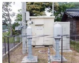
環境放射線観測局 (大西局：志賀町(地図下線)) 空間放射線や風向、風速などを測定しています。
