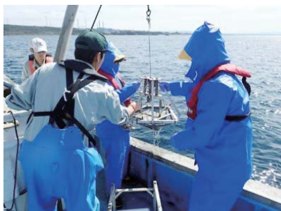
採泥器で底質を採取するようす
