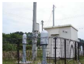
環境放射線観測局 (能登部局：中能登町(地図赤下線)) 空間放射線や風向、風速などを測定しています。
