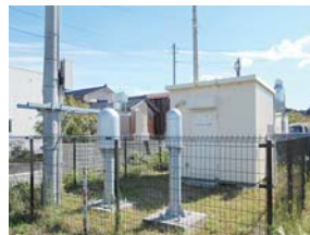
環境放射線観測局 (大町局：穴水町(地図赤下線)) 空間放射線や風向、風速などを測定しています。
