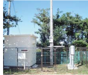
環境放射線観測局 (一ノ宮局：羽咋市) 空間放射線や風向、風速などを測定しています。
