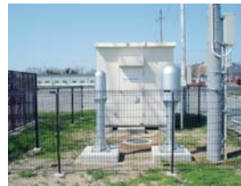
環境放射線観測局 (押水局(宝達志水町)) 空間放射線や風向、風速などを測定しています。
