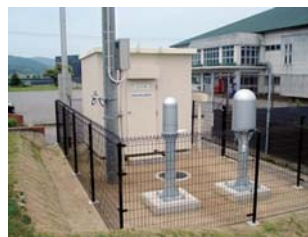
環境放射線観測局 (志賀局(宝達志水町)) 空間放射線や風向、風速などを測定しています。
