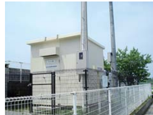
環境放射線観測局 (東湊局(七尾市)) 空間放射線や風向、風速などを測定しています。
